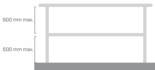
BARANDA SIN RODAPIÉ
