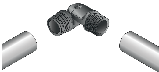
13 - Insérer les angles des lisses et des sous-lisses.
