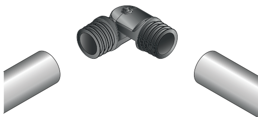
13 - Die Winkelstücke der Handläufe und der Zwischenläufe einsetzen.
