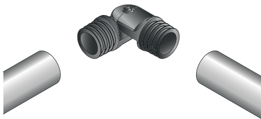
13 - Introducir los ángulos en los pasamanos y las barras intermedias.
